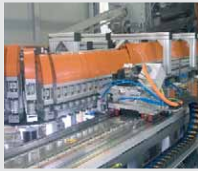
Transportsystem durch die Heizstrecke
